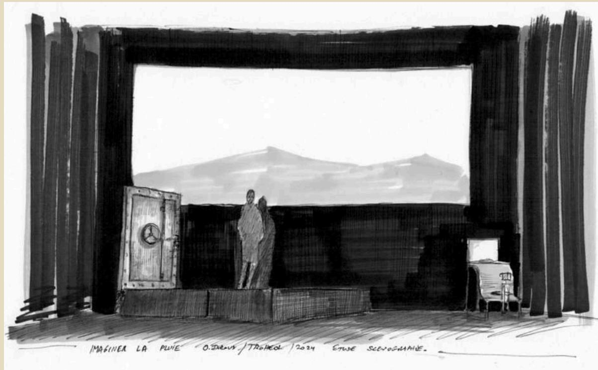
L'espace de jeu est fermé au lointain par un cyclorama de 5x2m surélevé, placé au centre du plateau à 2,5m derrière les praticables et la table vidéo. Il accueille les images créées en direct au plateau.
